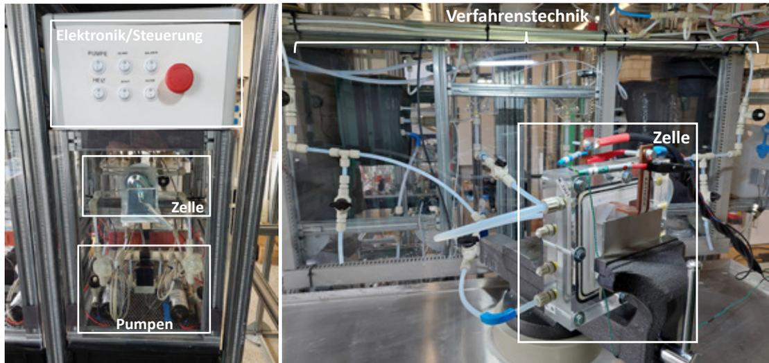
Abbildung 3: Im Rahmen des StaR-Projekts in Betrieb genommene Testfelder für Laborzellen unterschiedlicher Zellfläche. Links: Teststand zur Charakterisierung von Drahtmaterialien und Elektrodenmaterialien mit einer aktiven Fläche bis  $3 \text{ cm}^2$ . Rechts: Teststand zur Bewertung der Zelldesigns und Materialien mit einer aktiven Fläche bis  $100 \text{ cm}^2$ .
