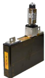
Abbildung 3: Links schematische Darstellung der Zusammenhänge zwischen den Zersetzungsprozessen und deren messbaren Folgen. Rechts ist der Aufbau zur Messung des Zellinnendrucks dargestellt.
